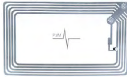
Abb. 1: RFID Tag mit Chip (dunkler Punkt rechts) und Antenne.
