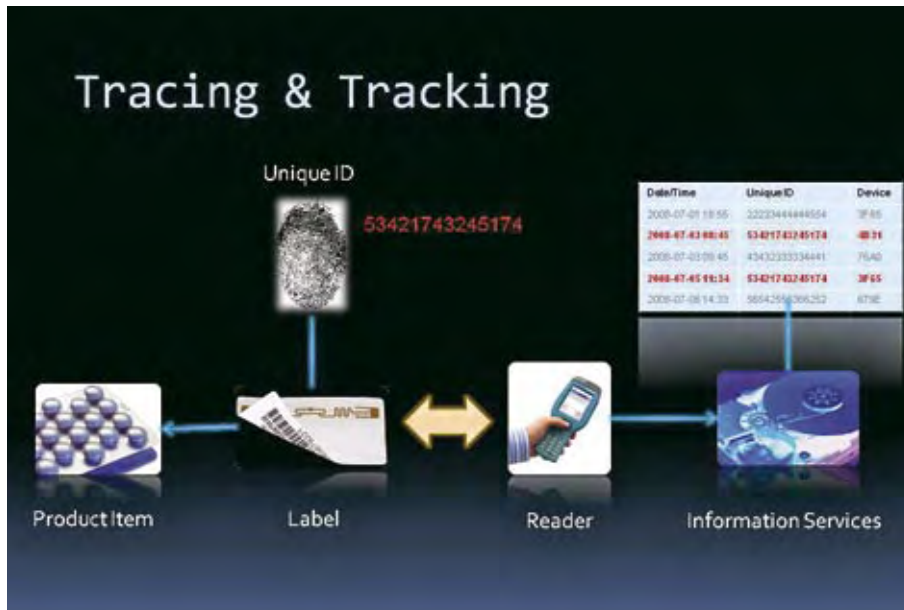
Abb. 3: Funktionsweise eines Track&Trace Systems für Arzneimittel.
